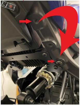
Schritt 3: Montieren Sie an der Rechte Seite der neue Bremsflüssigkeitsbehälter mit den mitgelieferte Schwarze M8 Schrauben. Und dann der Bremsflüssigkeitsbehälter montieren mit den originale M5 Schraube. An der Rückseite eine mitgelieferte Unterlegscheibe und M5 Mutter nutzen und festdrehen.
