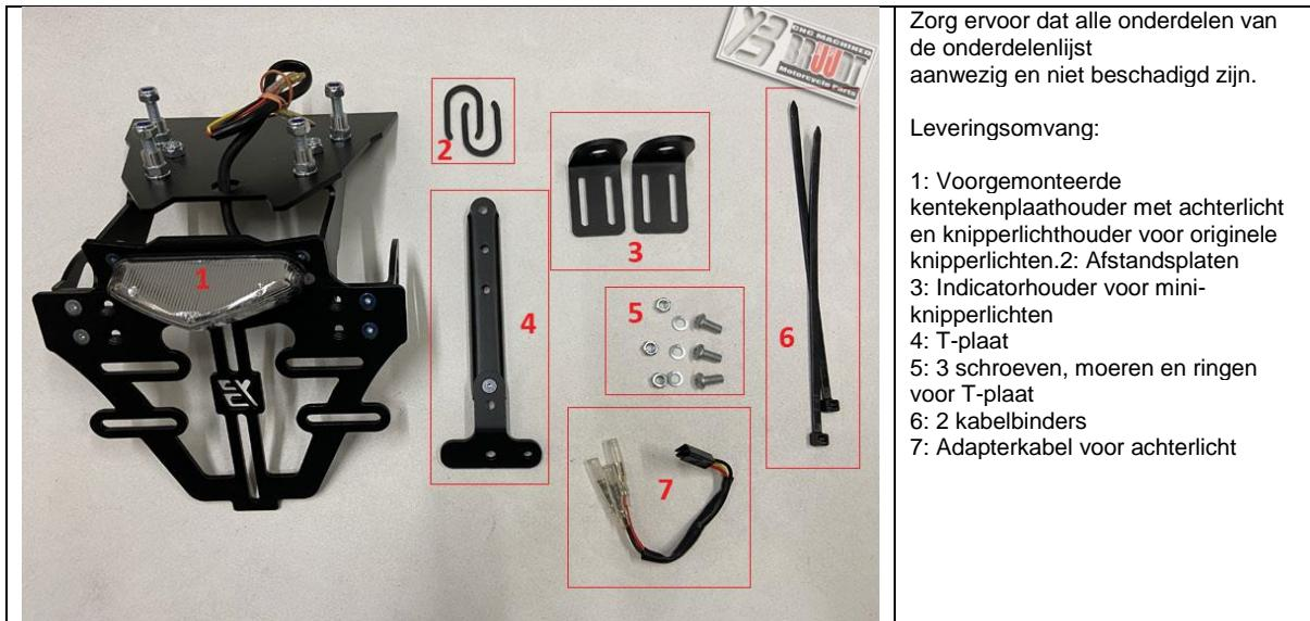
Zorg ervoor dat alle onderdelen van de onderdelenlijst aanwezig en niet beschadigd zijn.
