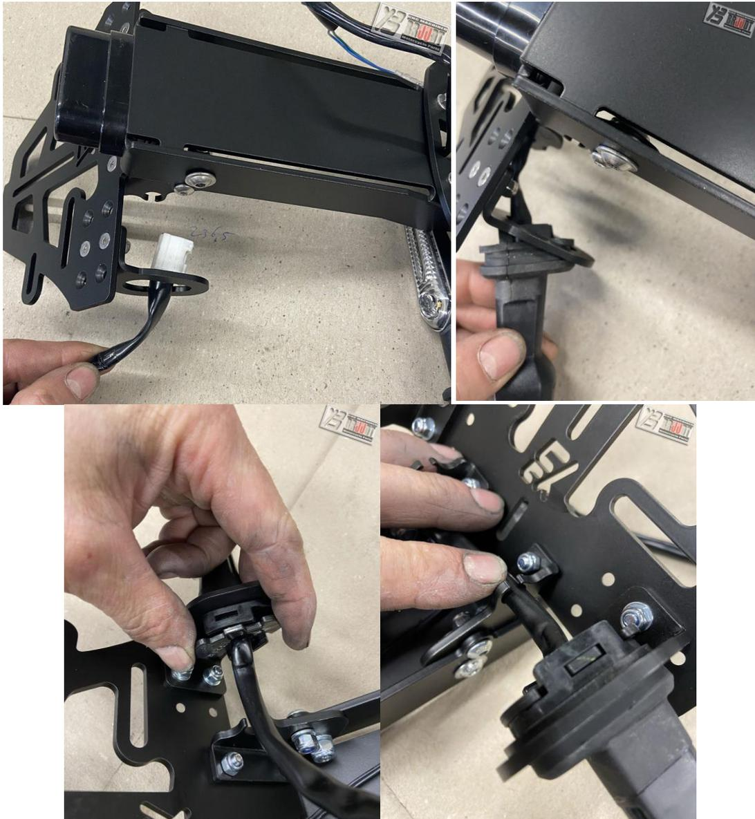
🇩🇪 Wenn die Original Blinker wieder montiert sind Wackeln die noch. Dafür sind die Distanz Bleche mitgeliefert. Stecken sie die Distanz Bleche zwischen das Gummi und Blinker Halter.
