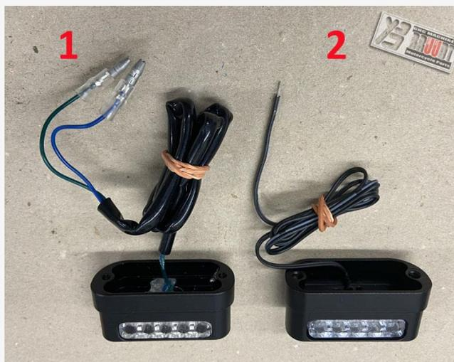
🇩🇪 Für die Kennzeichenbeleuchtung ohne Stecker nutzen wir die mitgelieferte Lötverbinder. Schneiden Sie das originale Kabel der Kennzeichenbeleuchtung durch (etwa 10 cm) durch. Entfernen Sie die Isolierung etwa 3-5 mm von den Kabeln. Verbinden Sie beide Kabel mit den Lötverbindern. Für die Verbindungen können Sie ein Heißluftgebläse oder Feuerzeug verwenden. Wenn Sie dies
