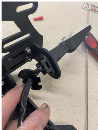
🇩🇪 Wenn die Original Blinker wieder montiert sind Wackeln die noch. Dafür sind die Distanz Bleche mitgeliefert. Stecken sie die Distanz Bleche zwischen das Gummi und Blinker Halter. Als letzte das Schwarze Plastik Teil wieder montieren.
