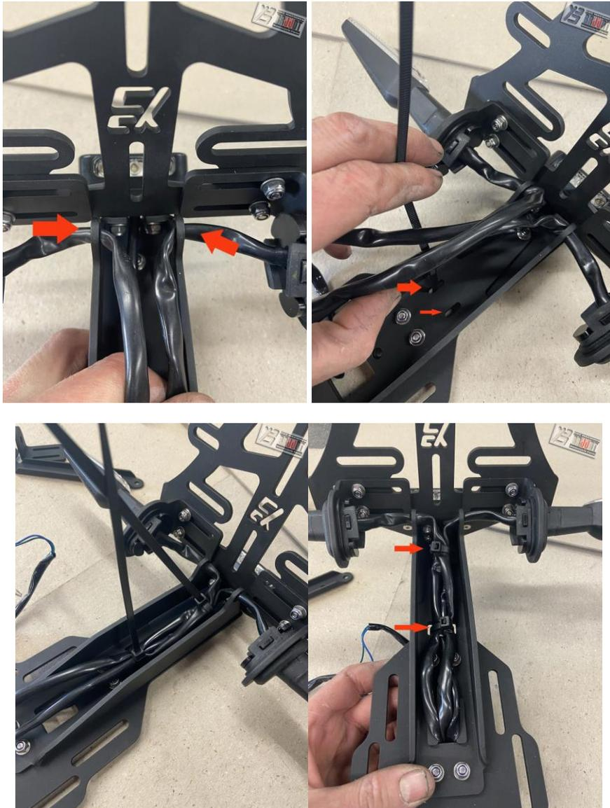
🇩🇪 Gegen Spritzwasser ist eine Kabel Abdeckung im Lieferumfang enthalten. Montieren Sie das jetzt.
